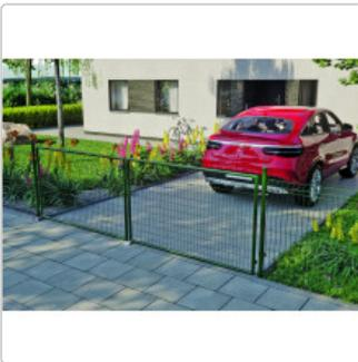
STRONG-Stabmatten bestehen aus einer Einfachstab-Verarbeitung mit 2 V-Sicken, die für hohe Stabilität sorgen. Die Drahtstärke beträgt 4,5 mm, die Maschenweite 50 x 200 mm. Einseitiger Drahtüberstand verhindert das Übersteigen des Zauns. Die gesamte Serie ist verzinkt und pulverbeschichtet. Die Tore werden inklusive der Pfosten und Beschläge geliefert, die Matten werden mit Kunststoffverbindungselemente an den Pfosten befestigt. So entsteht eine stabile und unaufdringliche Vorgartenzaunanlage.
