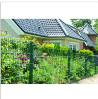
COMO-Doppelstabmatten sind die leichteren Varianten und speziell für den Endverbraucher konzipiert. Geringeres Gewicht erleichtert die Montage, während die Stabilität trotzdem ausreicht. Die einzelnen Matten sind 250 cm breit, gefertigt aus stabilen Dächten mit Drahtstärken 6/5/6 mm, einseitigem Überstand der Mitteldrähte (entweder Übersteigschutz oder als Schutz vor Kleingetier), mit Maschenweite 50 x 200 mm, verzinkt und/oder pulverbeschichtet grün (RAL 6005) oder anthrazit (RAL 7016).
