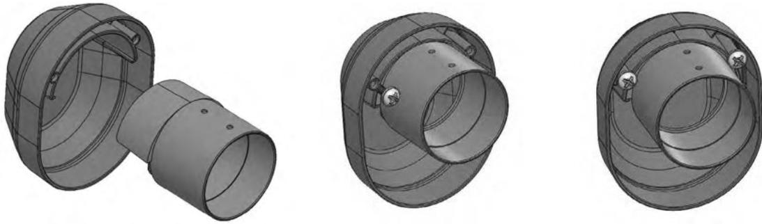
Die zusammengebauten Teile werden dann wie in den vorherigen Abschnitten gezeigt als Rohrenden montiert. Es ist auch möglich, den Regenmantel an einem horizontalen Rohrende unter anspruchsvolleren Bedingungen zu verwenden, um einen besseren Schutz gegen Wetter und Wind zu gewährleisten.
