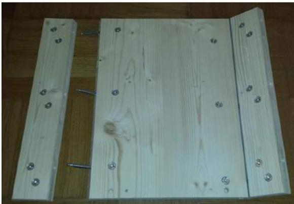
Auch in die restlichen Längsbohrungen der Eckteile vorne (T6) stecken wir Gelenk Mini Fix Verbinder (J) ein und ziehen diese dann leicht fest.
