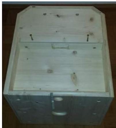
In dieser Einbaustellung wird auf der linken Seite (T4) eine Schraube 4 x 30 (H) in ein kleines 3 mm Loch im oberen Bereich zu 1/3 rein geschraubt, diese dient als Halterung für den Kanisterdeckel.
