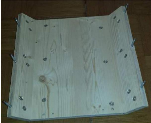
Wir stellen die bisher zusammengebauten Teile auf. Die Bohrungen am Vorderteil schauen nach unten. Dann schieben einen Gelenk Mini Fix Verbinder (J) nach dem anderen in die Längsbohrungen der Seiten (T4 & T5). Ist das geschafft, ziehen wir alle Mini Fix Hülsen fest.
