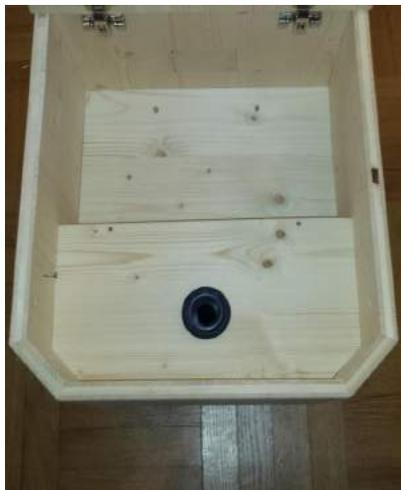
Damit der Schlauch nach hinten hinaus geführt werden kann, müssen wir noch den kleinen vorgefrästen Ausschnitt in der Mittelwand (T3) per Hammer heraus nehmen. Dazu schlagen wir von vorne auf den Ausschnitt und brechen ihn so heraus.
