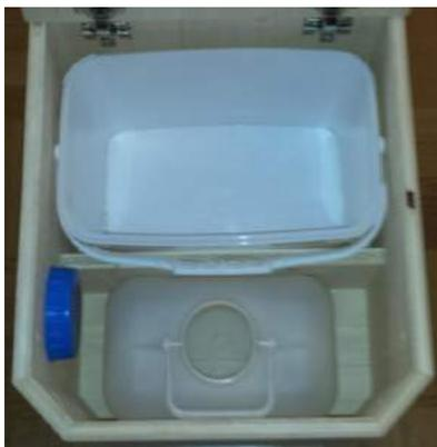
Egal welche Einbaustellung Sie wählen, zuletzt muss noch die Klappe (T10) angebaut werden. Dazu klinken wir die Topfscharniere (B) in die großen Bohrungen in der Klappe (T10). Dann stecken wir die Topfscharniere (B) in Scharnier Grundplatten (C). Wer dies noch nie gemacht hat, muss etwas probieren. Die Topf Scharniere (B) haken ein, wenn auf den hinteren Teil des Beschlages gedrückt wird.
