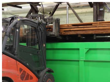
Treatment bath • Tauchanlage für Holzschutzmittel • Bain de traitement • Baño de tratamiento • Bagno di trattamento
