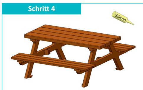
Decken Sie alle Schraubsenkungen mit Silikon ab und streichen Sie es anschließend glatt.
