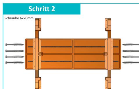
Richten Sie den Fuß an den äußeren Anschlägen (siehe Schritt 1) der Tischplatte aus. Verschrauben Sie den Fuß durch die vorgebohrten Bohrlöcher mit der Tischplatte. Mit je 4 Schrauben (6x70mm) von außen.
