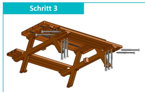
Stellen Sie die Sitzgruppe auf und richten Sie die Anschläge der Sitzelemente an den Füßen aus. Verschrauben Sie das Sitzelement mit je 4 Schrauben (6x70mm) von unten und je 6 Schrauben (6x60mm) von der Seite durch die vorgebohrten Bohrlöcher.
