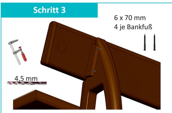
Verfahren Sie mit der Montage des Rückenbrettes entsprechend Schritt 2. Bohrungen gemäß Bohrbild Seite 1, d.
