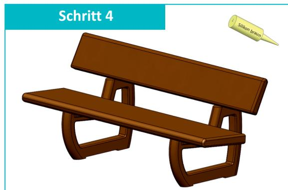
Decken Sie alle Schraubensenkungen mit Silikon ab und streichen Sie es anschließend glatt.
