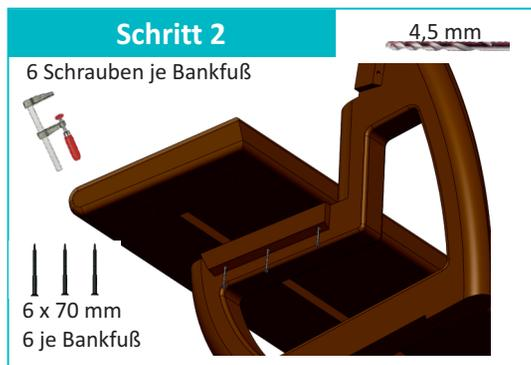
Das Sitzbrett gleichmäßig an den Bankfüßen ausrichten und mit Schraubzwingen fixieren (die Montage auf einer Werkbank kann den Aufbau erleichtern). Verschraubungen gemäß Bohrbild Seite 1, a-c, vornehmen. Vorbohren mit Bohrer 4,5mm, 11mm Bohrer zum versenken der Schraubköpfe.
