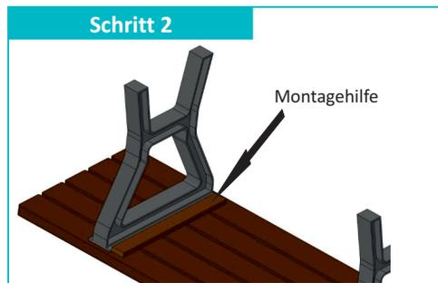
Richten Sie den Tischfuß mittig, mit Hilfe der vormontierten Montagehilfe, an dem Tischelement aus. Die Montagehilfe dient als Anschlag an den Tischfuß.
