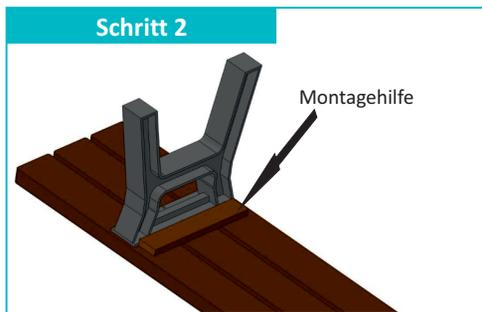
Richten Sie den Bankfuß mittig, mit Hilfe der vormontierten Montagehilfe, an dem Sitzelement aus. Die Montagehilfe dient als Anschlag an den Bankfuß.
