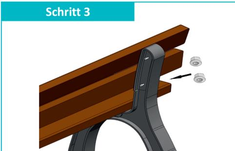
Richten Sie das vormontierte Rückenelement an den Vorbohrungen des Bankfußes aus und verschrauben Sie es pro Bankfuß mit je 2 Schrauben (M8x30mm), Muttern und 4 Unterlegscheiben.
