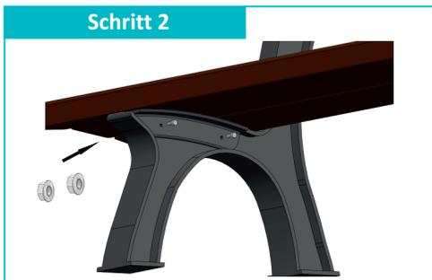
Richten Sie das vormontierte Sitzelement in den Vorbohrungen des Bankfußes aus und verschrauben Sie es mit je 2 Schrauben (M8x30mm), Muttern und 4 Unterlegscheiben pro Bankfuß.
