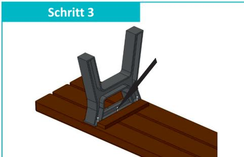
Verschrauben Sie das Sitzelement mit je 6 Schrauben (6x40mm) pro Bankfuß. Anschließend kann die Montagehilfe bei Bedarf entfernt werden.
