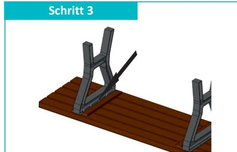
Verschrauben Sie das Tischelement mit je 10 Schrauben (6x40mm) pro Bankfuß. Anschließend kann die Montagehilfe bei Bedarf entfernt werden.
