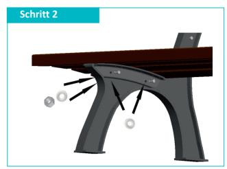
Richten Sie das vormontierte Sitzelement in den Vorbohrungen des Bankfußes aus und verschrauben Sie es mit je 2 Schrauben (8x30mm), 2 Muttern und 4 Unterlegscheiben pro Bankfuß.
