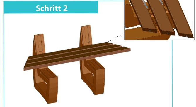
Legen Sie das Sitzelement auf den Bankfüßen auf. Die Verbinderr in den Aussparungen ausrichten und mit 4 Schrauben ( $\varnothing$  8x70 mm) befestigen. (Die Schrauben werden mit Ringen unterlegt) Anschließend werden die Schraubköpfe mit den Kappen abgedeckt.
