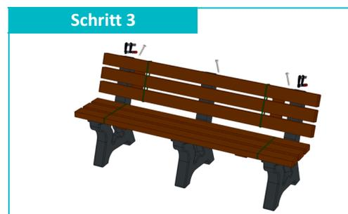
Richten Sie das Rückenelement mittig aus und befestigen Sie die Schraubzwingen. Verschrauben Sie die vorgebohrten Bankfüße mit je 12 Schrauben mit dem Rückenelement. Lösen Sie anschließend die Schraubzwingen.
