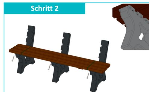
Legen Sie das Sitzelement (mit den Montagehilfen) auf die Bankfüße und richten es mittig aus. An der Vorderseite der Bank, sollte das Sitzelement 0,5 cm überstehen. Befestigen Sie das Sitzelement mit 12 Schrauben je Bankfuß (siehe Detailzeichnung) an den vorgebohrten Bankfüßen.
