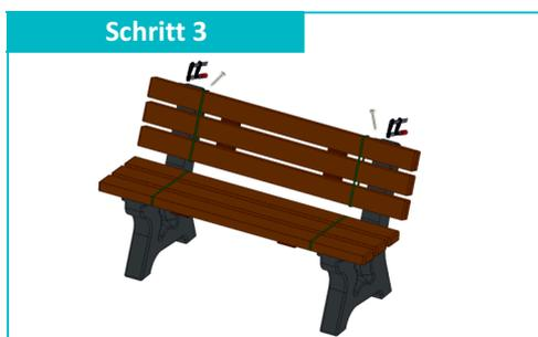
Richten Sie das Rückenelement mittig aus und befestigen Sie die Schraubzwingen. Verschrauben Sie die vorgebohrten Bankfüße mit je 12 Schrauben mit dem Rückenelement. Lösen Sie anschließend die Schraubzwingen.
