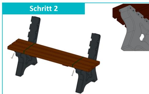
Legen Sie das Sitzelement (mit den Montagehilfen) auf die Bankfüße und richten es mittig aus. An der Vorderseite der Bank, sollte das Sitzelement 0,5 cm überstehen. Befestigen Sie das Sitzelement mit 12 Schrauben je Bankfuß (siehe Detailzeichnung) an den vorgebohrten Bankfüßen.
